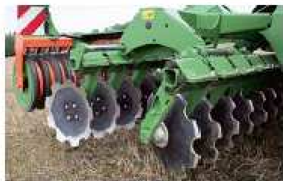
Die gerackten Scheiben haben einen Durchmesser von 51 cm, Auflager, Lager etc. Darüber abgerückt. Zukünftig gibt es neben der Keilringwalze fünf weitere Nachlaufwalzen im Programm.
