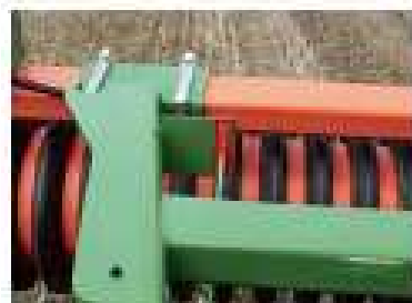
Eine gut sichtbare Skala informiert den Fahrer über die Arbeitstiefe. Die Differenzsprachen dabei nicht genau der tatsächlichen Tiefe.
